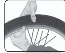
FIGURE C replace tyre onto rim.
